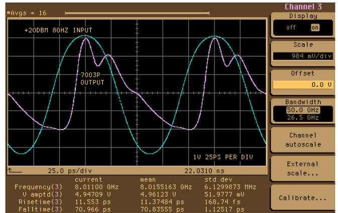
**Figure 10: Sine Wave Driven Edge Compressor**
