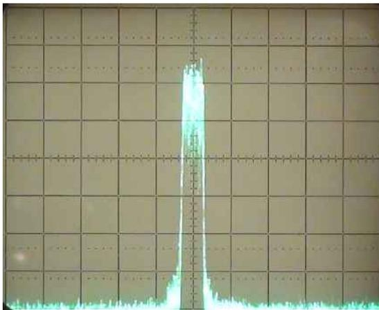
Fig. 4 64-QAM, DTV Spectrum
